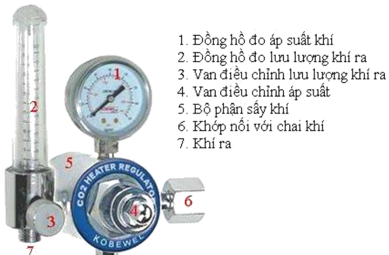
Hình 1. 8. Van giảm áp dùng trong hàn MAG
