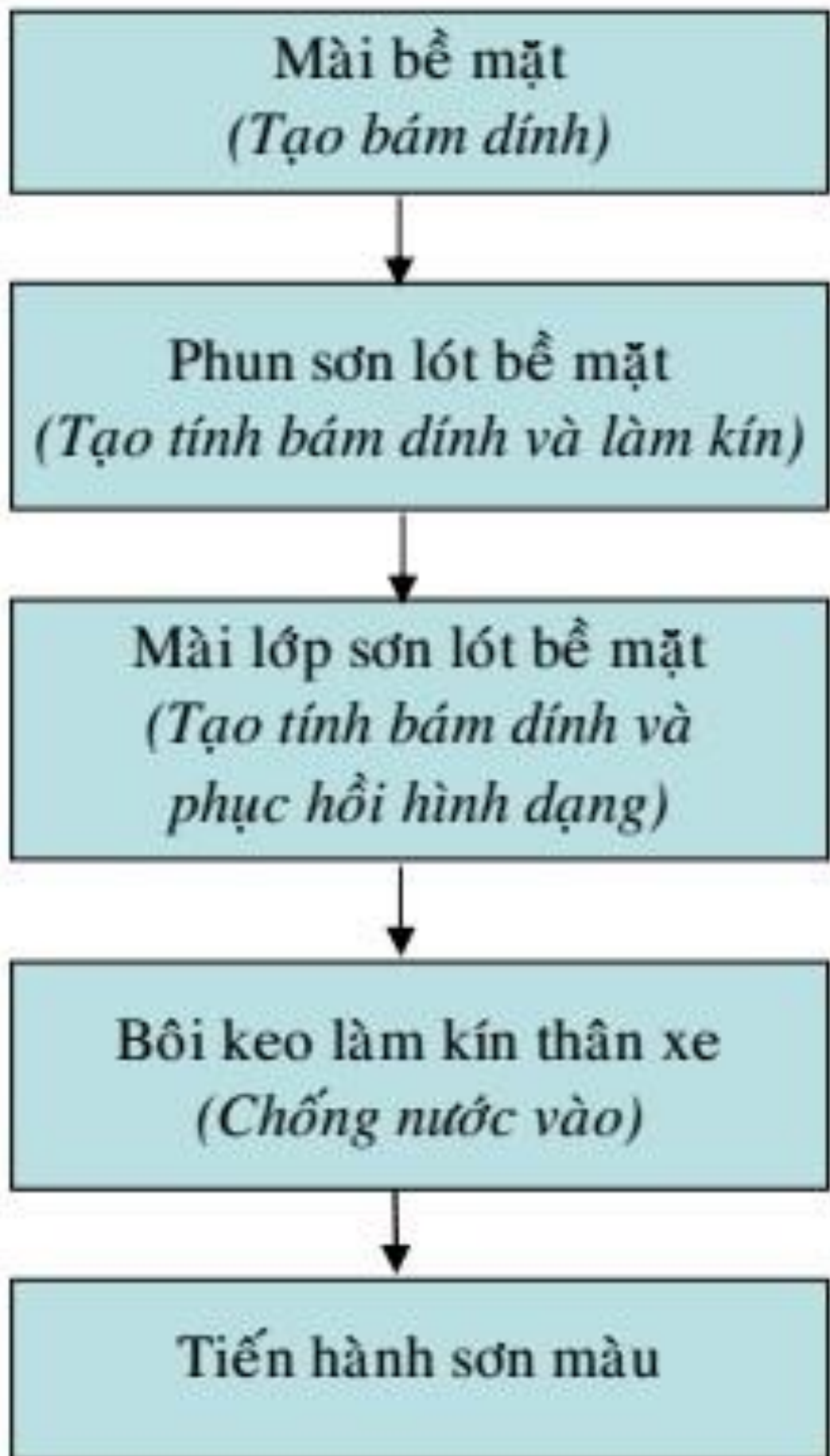
Hình 1.2. Sơ đồ quy trình chuẩn bị bề mặt cho tấm vỏ xe được thay thế
