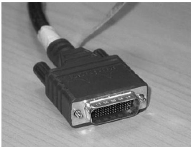
Hình 1.3: Đầu cáp DB-60 của một cáp serial dùng để kết nối đến các router 2500
