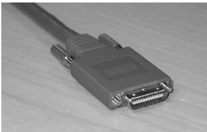
Hình 1.4: Cáp Smart Serial (1700, 1800, 2600, 2800)
