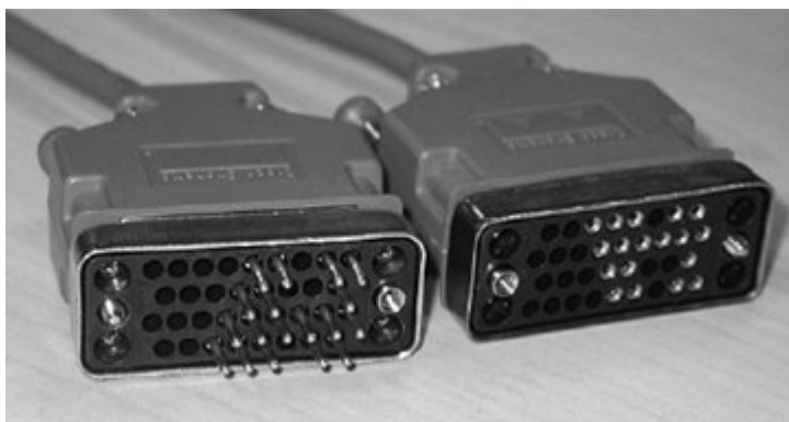
Hình 1.4: Cáp Smart Serial (1700, 1800, 2600, 2800)
