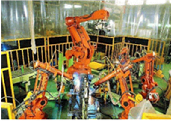
a. Hệ thống robot hàn điện khung xe moto
