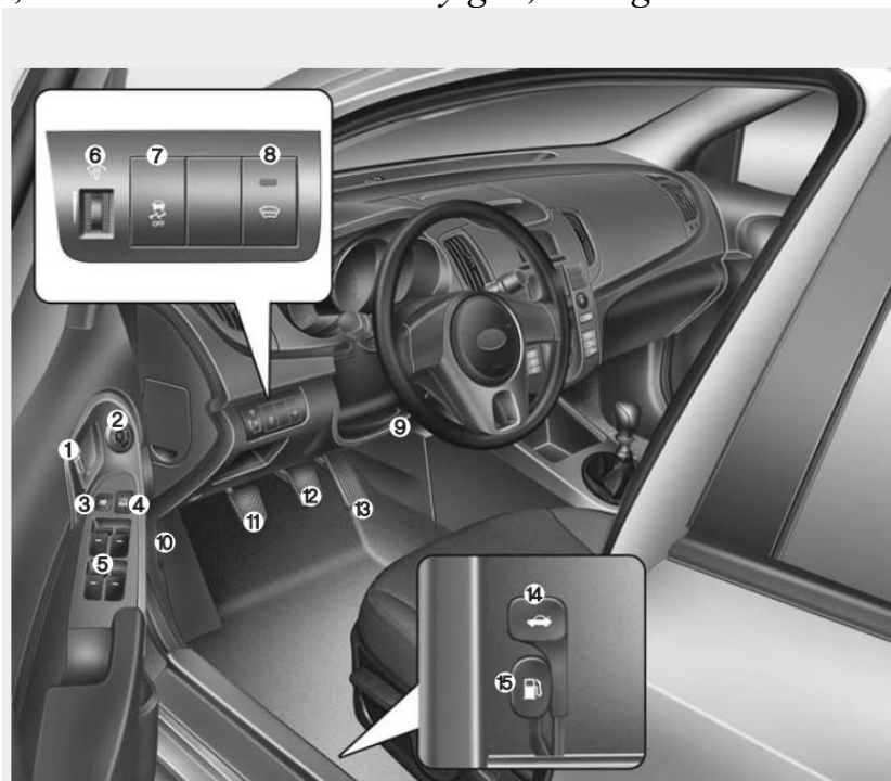
Hình 1-1c- Các bộ phận chủ yếu trong buồng lái ô tô số cơ khí 1-Chốt cửa; 2-Nút điều chỉnh gương chiếu hậu; 3-Nút khóa cửa sổ kính; 4- Nút khóa cửa trung tâm; 5- các nút bấm nâng, hạ cửa kính; 6- Nút điều chỉnh độ sáng bảng đồng hồ; 7- Nút bấm tắt bật hệ thống ESC; 8- Nút bấm chế độ tự động gạt mưa kính trước; 9- Cần khóa điều chỉnh vị trí vô lăng; 10- cần mở nắp khoang động
