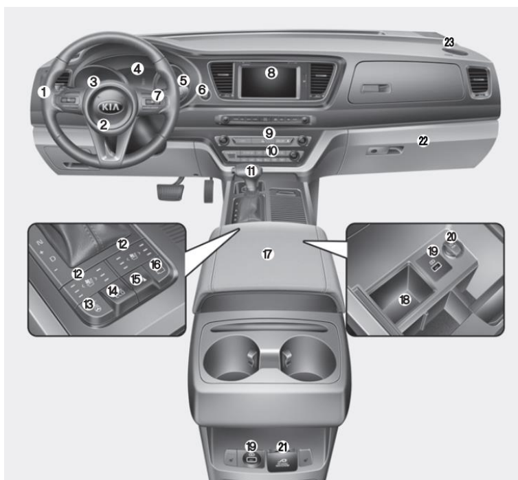
Hình 1-1b- Các bộ phận chủ yếu trong buồng lái ô tô số tự động 1-Công tắc đèn chiếu xa/gần; 2-Công tắc còi; 3,4,5-bảng đồng hồ; 6-Công tắc khởi động/tắt động cơ; 7-Nút bấm chức năng trên vô lăng; 8-Màn hình hiển thị đa chức năng; 9-Nút bấm điều khiển điều hòa không khí; 10-Hệ thống giải trí; 11-Cần gài số; 12,13,14,15,16-Nút bấm điều khiển sấy ghế; 17-Ngăn để đồ.
