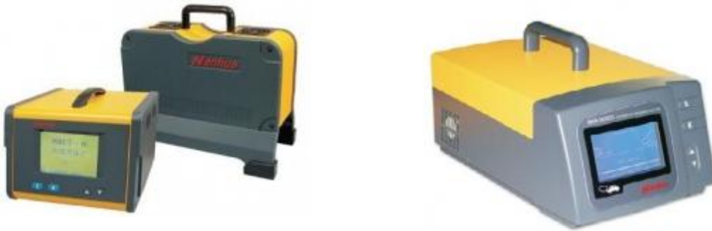
Hình 7.3 Thiết bị phân tích khí xả
