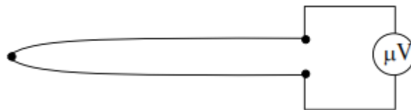
Hình 1.10 Sơ đồ mạch đo nhiệt độ bằng cặp nhiệt
