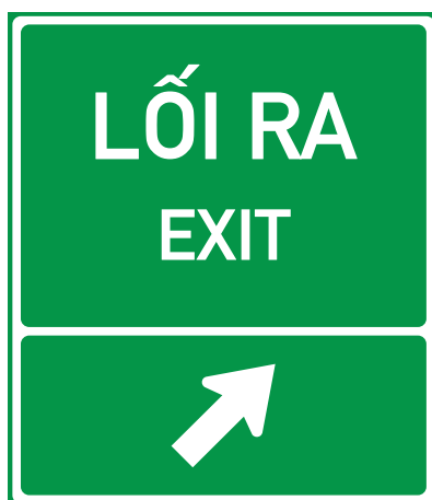
Hình 33 - Biển số IE.474 chỉ dẫn lối ra
