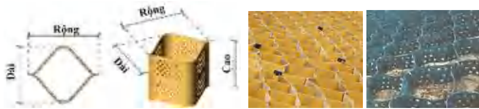
Hình 1: Kết cấu cơ bản của Neoweb
