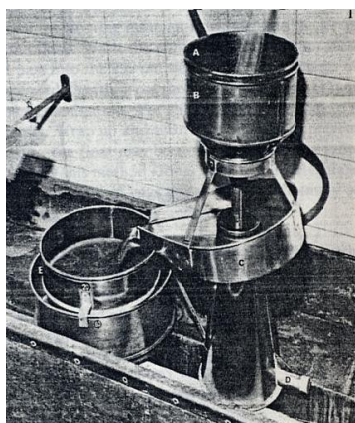
Hình 1. Bình Fenwick để tách bào nang trong đất
