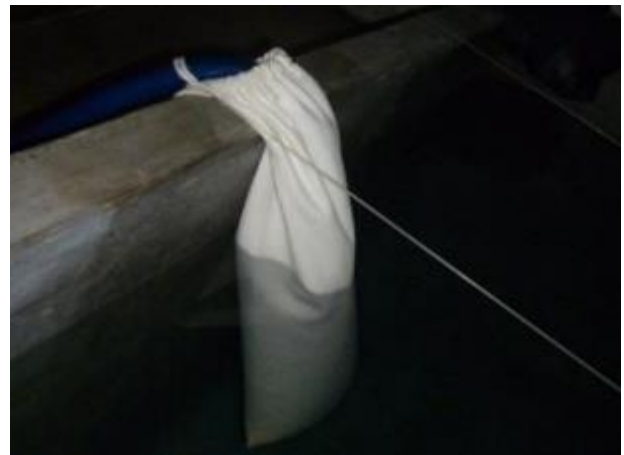
Hình 4.1.1. Cấp nước qua túi lọc vải
