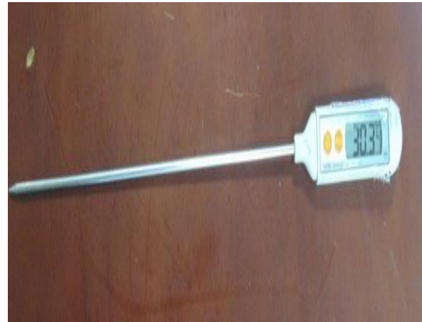
Hình 6.1.8: Dụng cụ đo nhiệt độ trung tâm sản phẩm
