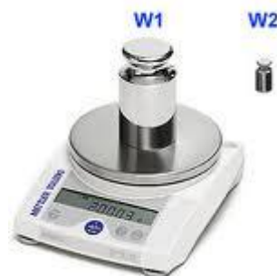
Hình 4.1.8: Kiểm tra cân bằng quả cân
