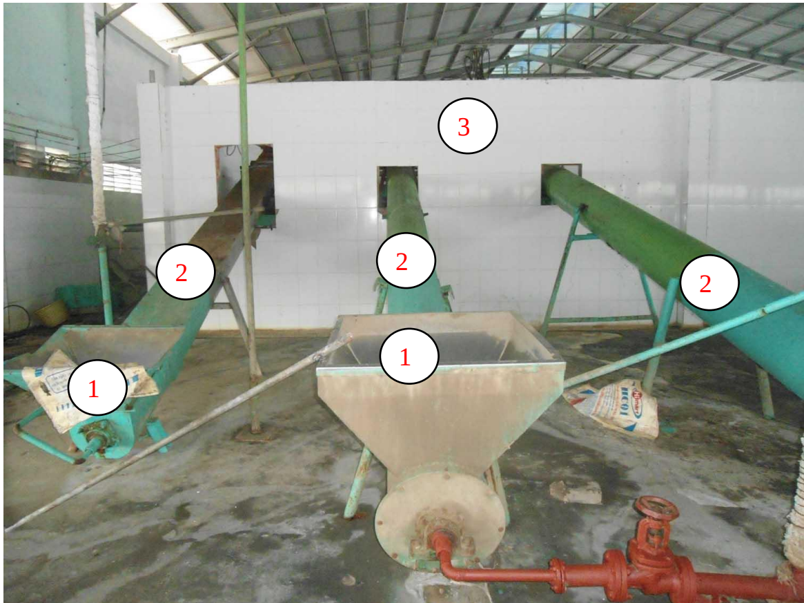
Hình 4.1.18. Hệ thống hấp nghêu (3 cửa tiếp liệu)
