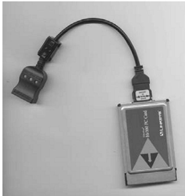
Hình 7-4: Card mạng PC16-bit sử dụng đoạn cáp ngắn (đôi khi gọi là dongle) để kết nối với khe cắm Ethernet.
